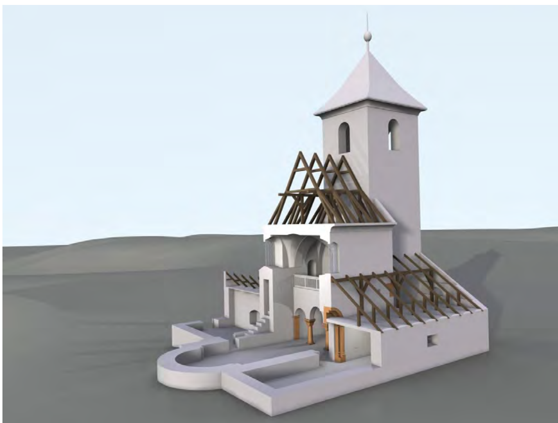
Obr. 14: Vysoký Újezd nad Dědinou (okr. Rychnov nad Kněžnou), kostel sv. Jakuba Většího. Vizualizace současného stavu – řez (model M. Falta 2012).
