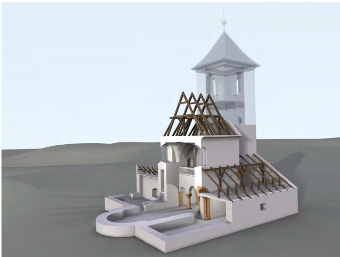
Obr. 15: Vysoký Újezd nad Dědinou (okr. Rychnov nad Kněžnou), kostel sv. Jakuba Většího. Vizualizace současného stavu – řez s vyznačením novověké části věže (model M. Falta 2012).
